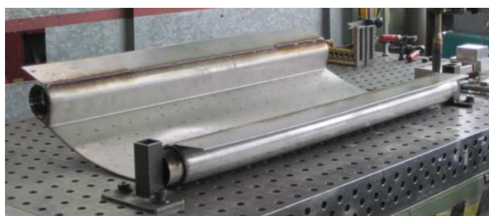
Figure 82 : Échangeur installé dans un ovoïde existant (Rabtherm), échangeur pour collecteur existant (Uhrig) (Lyonnaise des eaux)
